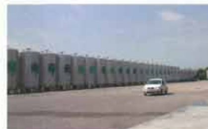
Edelstahlbottiche für die Fermentation von Tresker und Trauben.
