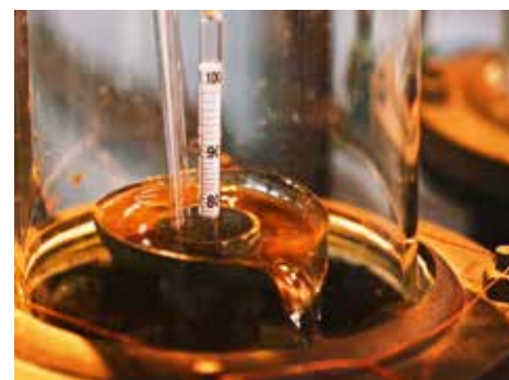
Der spezielle Glockenboden für eine langsame Destillation wurde von Benito Nonino entwickelt
