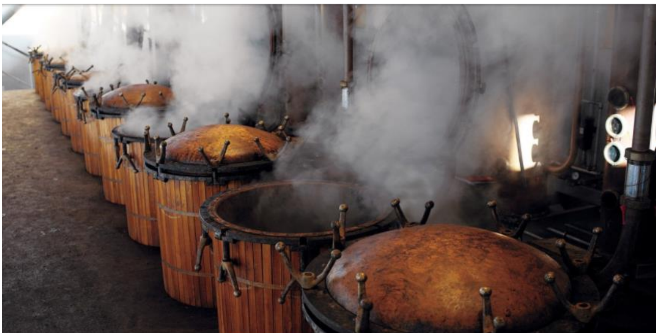
Gli alambicchi in rame discontinui a vapore della Distilleria Nonino
